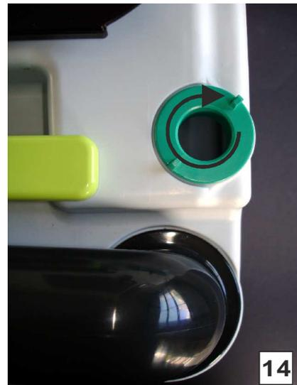
SOG-Schlauchanschluss in den Bajonett einsetzen und nach rechts drehen bis ein Einrasten des Schlauchanschlusses zu spüren ist. Sollte dies zu schwer gehen, O-Ring mit Silikonspray oder etwas Seife einreiben.
