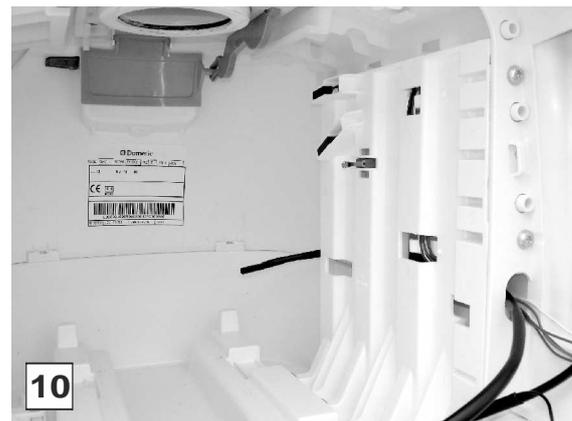
Monter d'abord le support de détecteur à contacts avant l'installation du harnais de câbles, voir image 7, 8, 9. Introduire le détecteur à contacts dans l'ouverture du câble et encastrer le détecteur à contacts dans le support de détecteur qui est monté.
