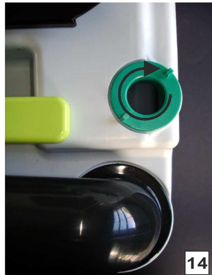
Mettre la connexion du tuyau SOG dans la baïonnette et tourner vers la droite jusqu'à sentir l'enclenchement de la connexion du tuyau. Si ceci devait être difficile, graisser l'anneau en O avec du spray de silicone ou un peu de savon.
