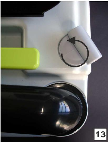
Dévisser de la cassette la valve de pression. Tourner vers la gauche la valve de pression jusqu'à la butée (voir image) et enlever en tirant vers le haut.
